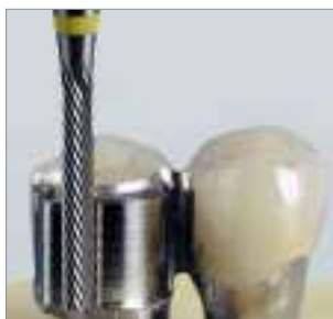
Fresaggio parallelo con chamfer. Fresado paralelo con filo biselado. Fresa de corte paralelo em ombro de preparo.
